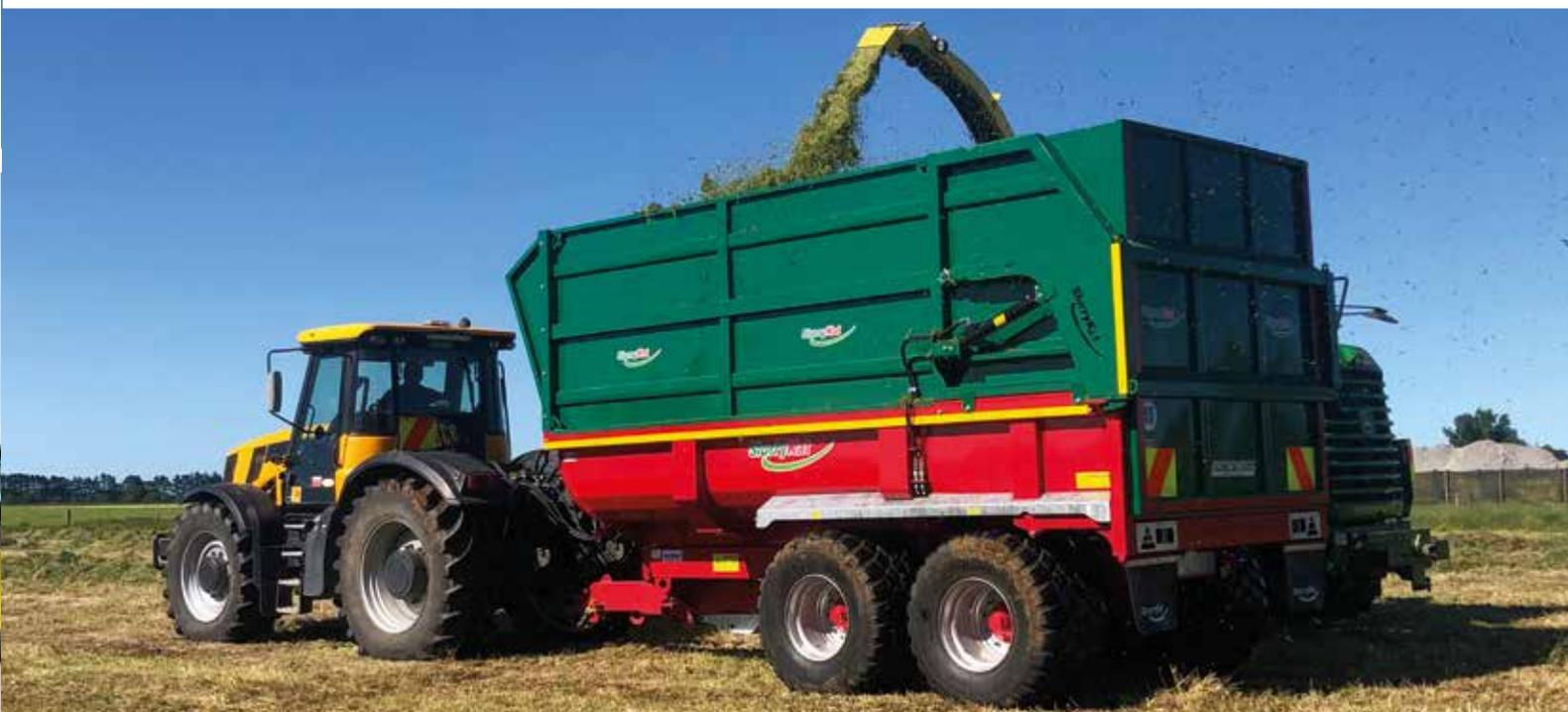
Lorsque le kit ensilage (panneaux verts) est installé sur la remorque, la porte TP reste en position ouverte à plat et à l'aide d'une vanne 3 voies, l'huile est dirigée vers la porte à ensilage.
