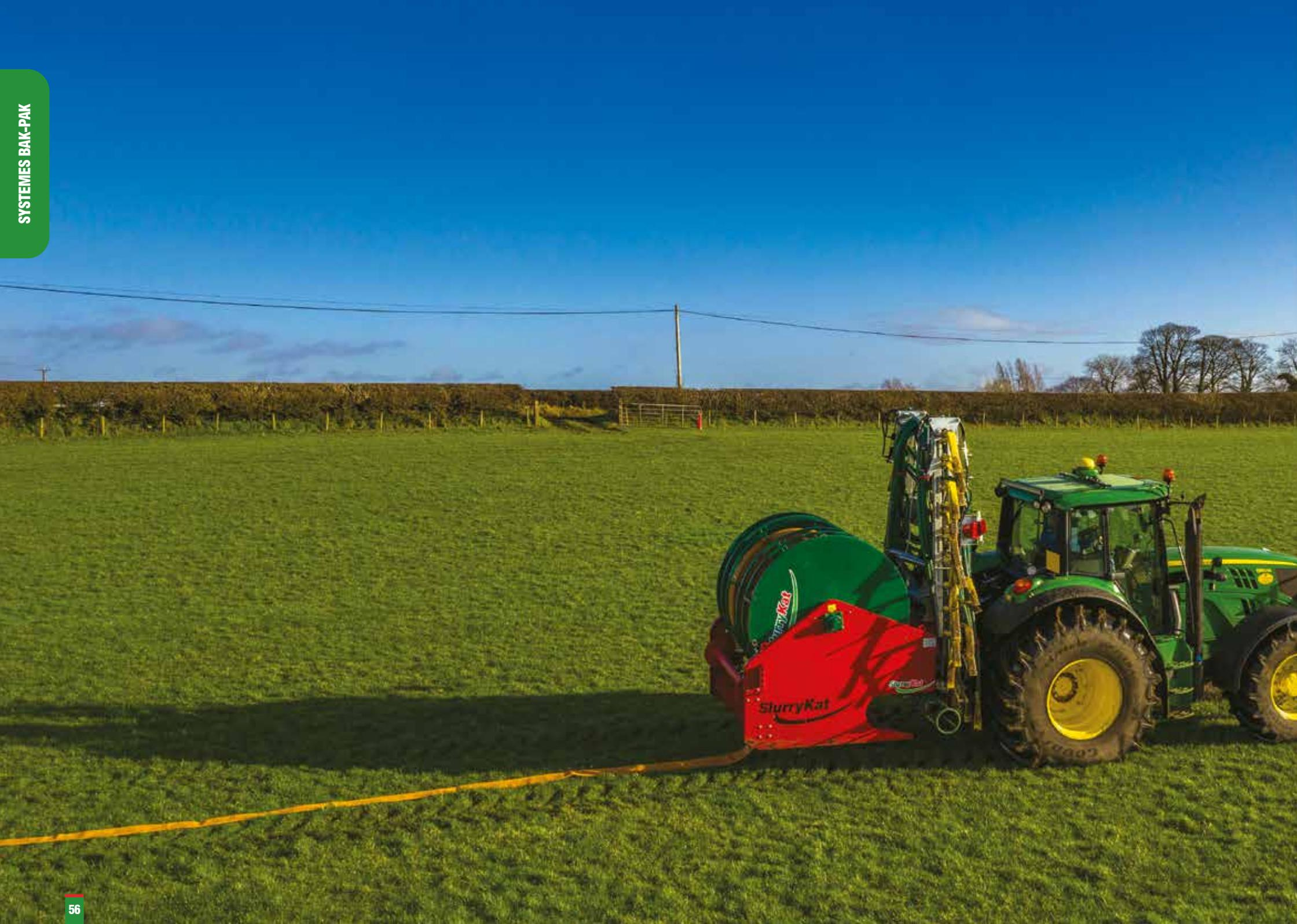
600m Mini - Bak Pak avec tuyaux plats Oroflex
