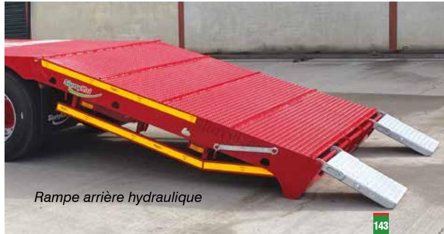
Rampe arrière hydraulique
