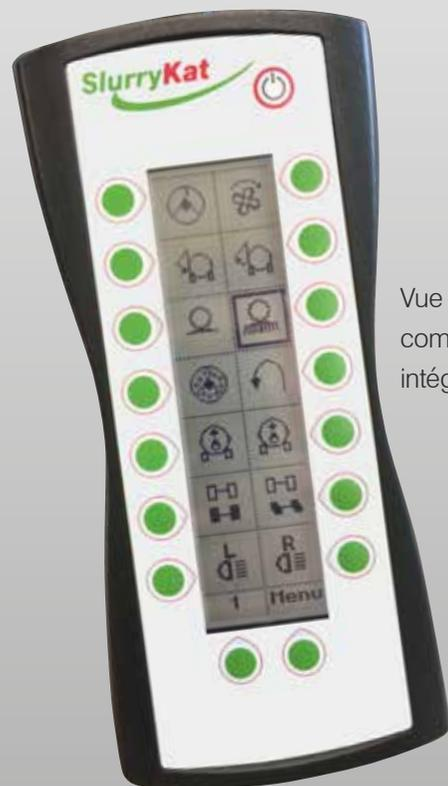
Vue de l'écran de commande hydraulique intégré secondaire
